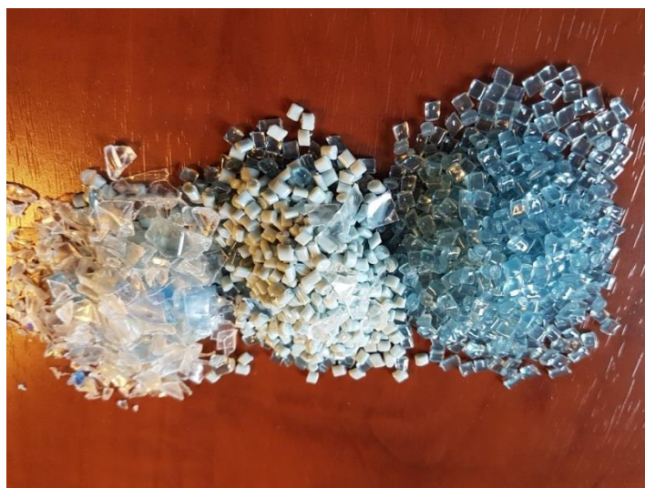
Paillettes de plastique broyées et lavées > matière recyclée secondaire
